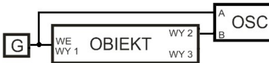
Rys. 2. Schemat blokowy układu do pomiaru współczynnika h_x
